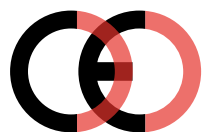
Falsk CE-mærke (for tæt på hinanden)
